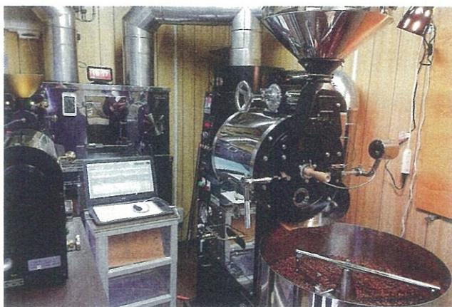
新焙煎所に導入した焙煎機と消煙装置
