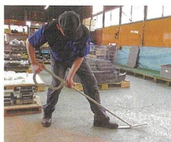
開発した除雪道具『ツルのアシ』。頑丈な作りとテコの原理で圧雪・凍結を簡単に剥ぎ取れる
